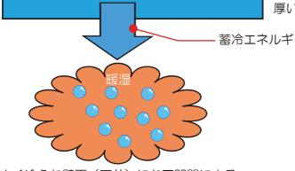
よく冷えた壁面(天井)にドア開閉による 暖かい湿った空気が侵入し、壁と接触すると・・。 暖かい湿った空気が冷えた壁面に冷やされ、 水分が表面に露出する。二結露
